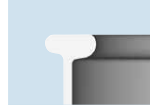
Flanş 1 Flanş genişliği 3,2 mm
