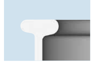
Flanş 2 Flanş genişliği 4 mm
