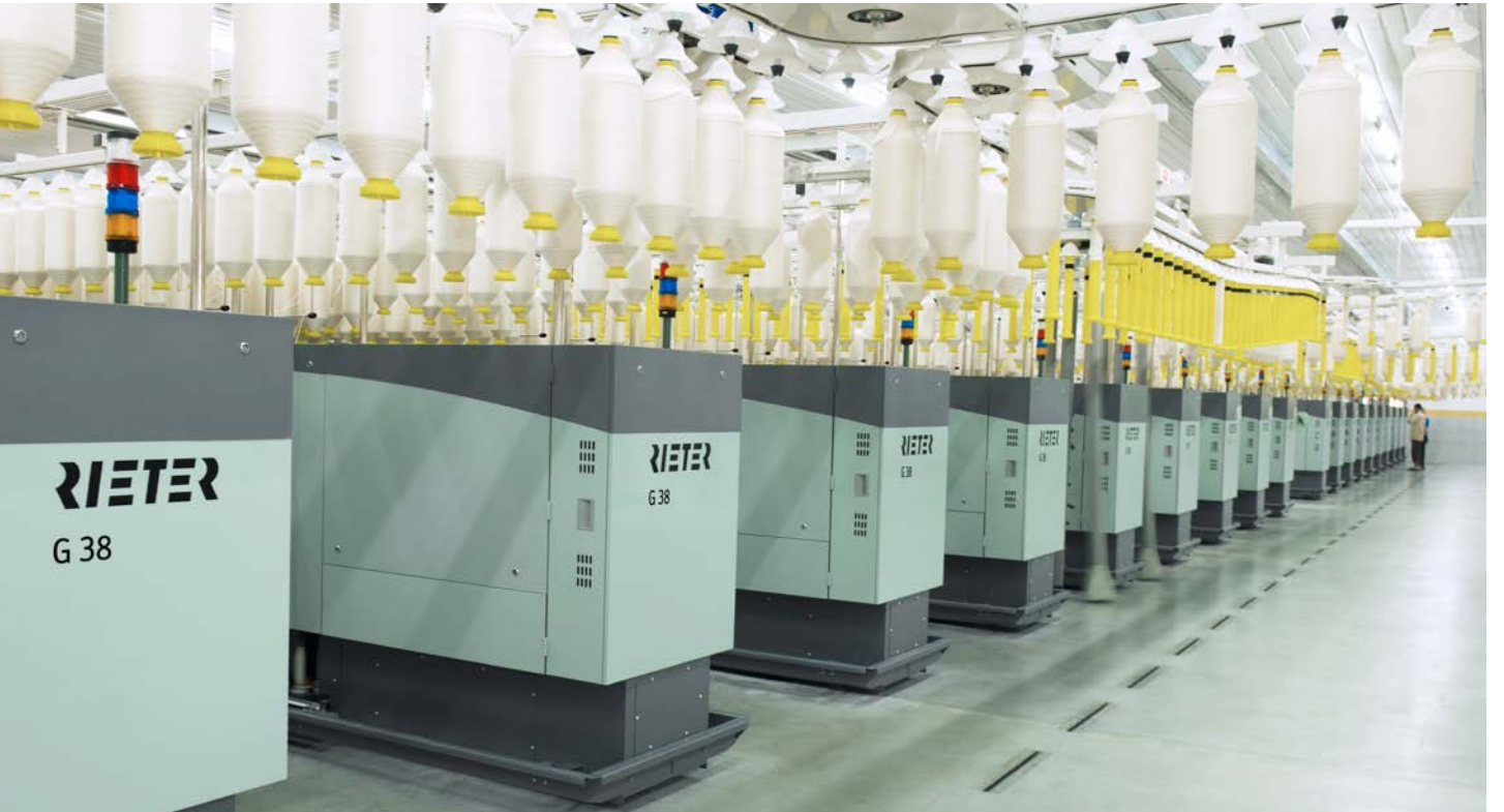
Şek. 1: Kantlanmış ring iplik makinası G 38, Yüksek-Hız Paketi ile %15'e varan daha yüksek iplik üretimine ulaşır.
