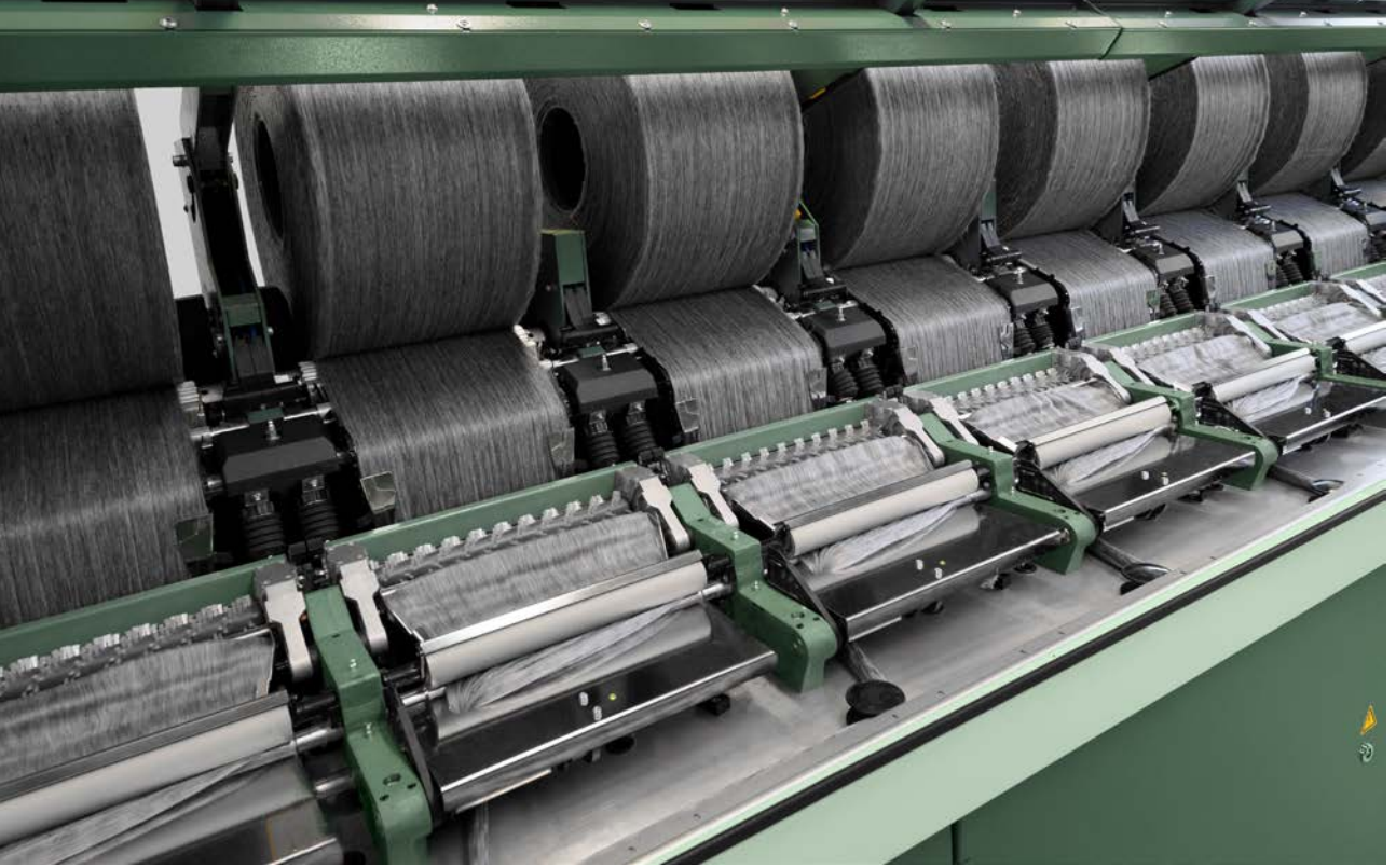
Şek. 2: Rahatsız edici kısa elyaf ve nepler tarak E 90 ile taranıp çıkarılır.
