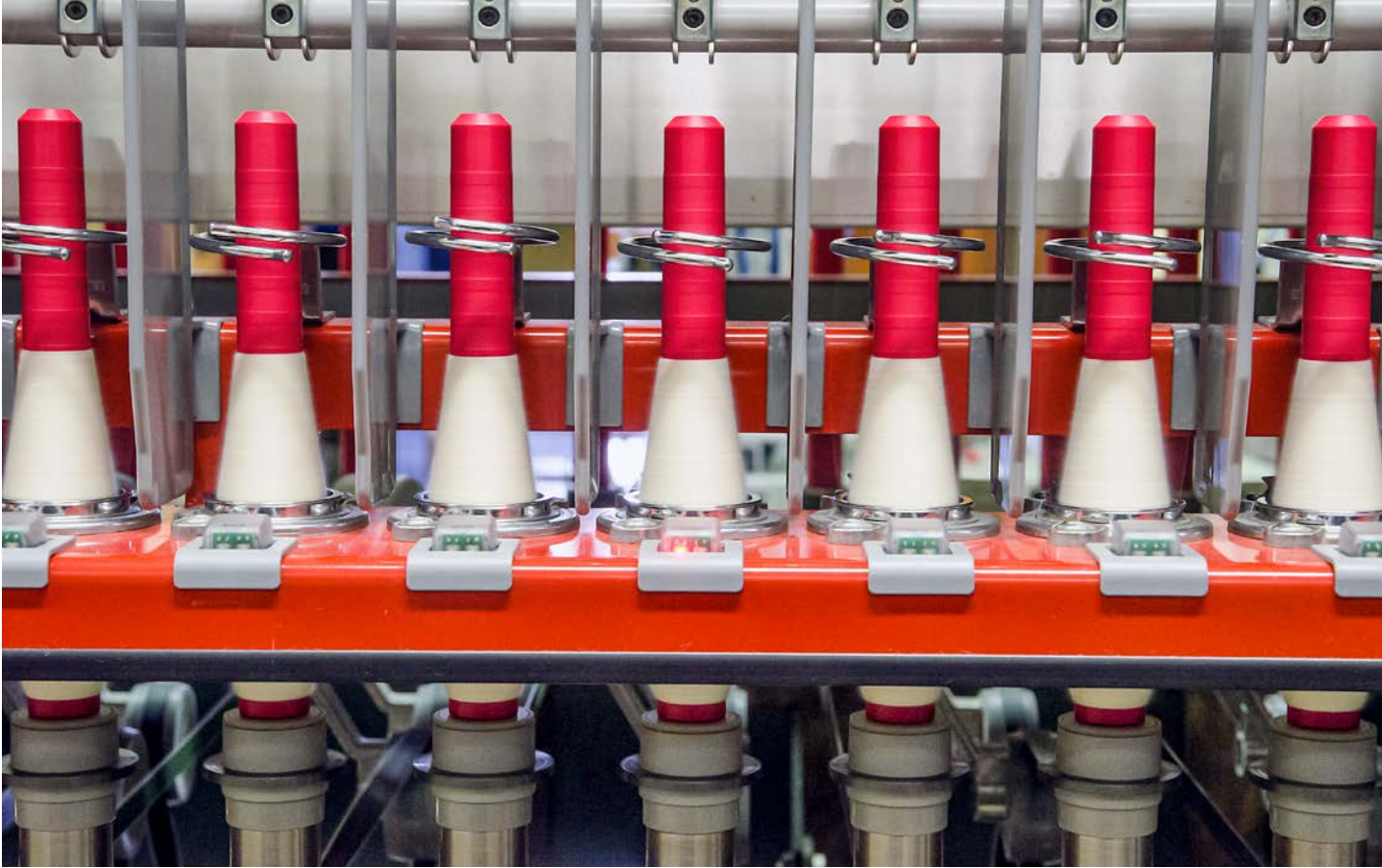
Şek. 3: Bağımsız iğ izleme sistemi ISM, etkilenen eğirme pozisyonunu tespit eder.
