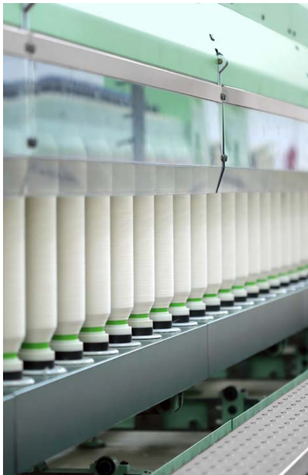
图2：可容纳224个锭子的粗纱机长车，向3至4台环锭细纱机供应原料。
