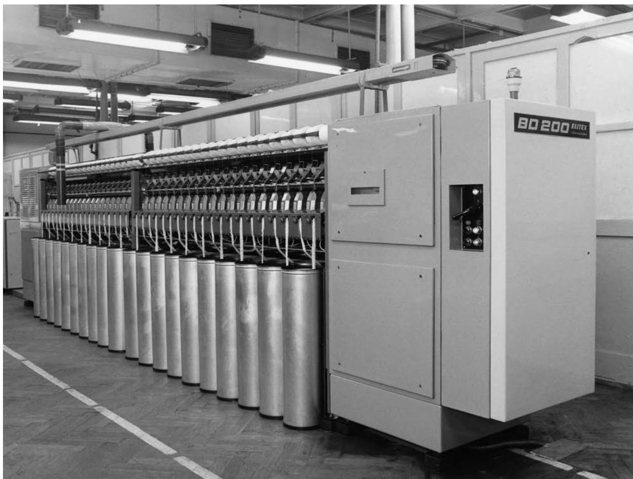
图4：转杯纺纱机BD 200-M-全球首台从条筒喂入条子的机型
