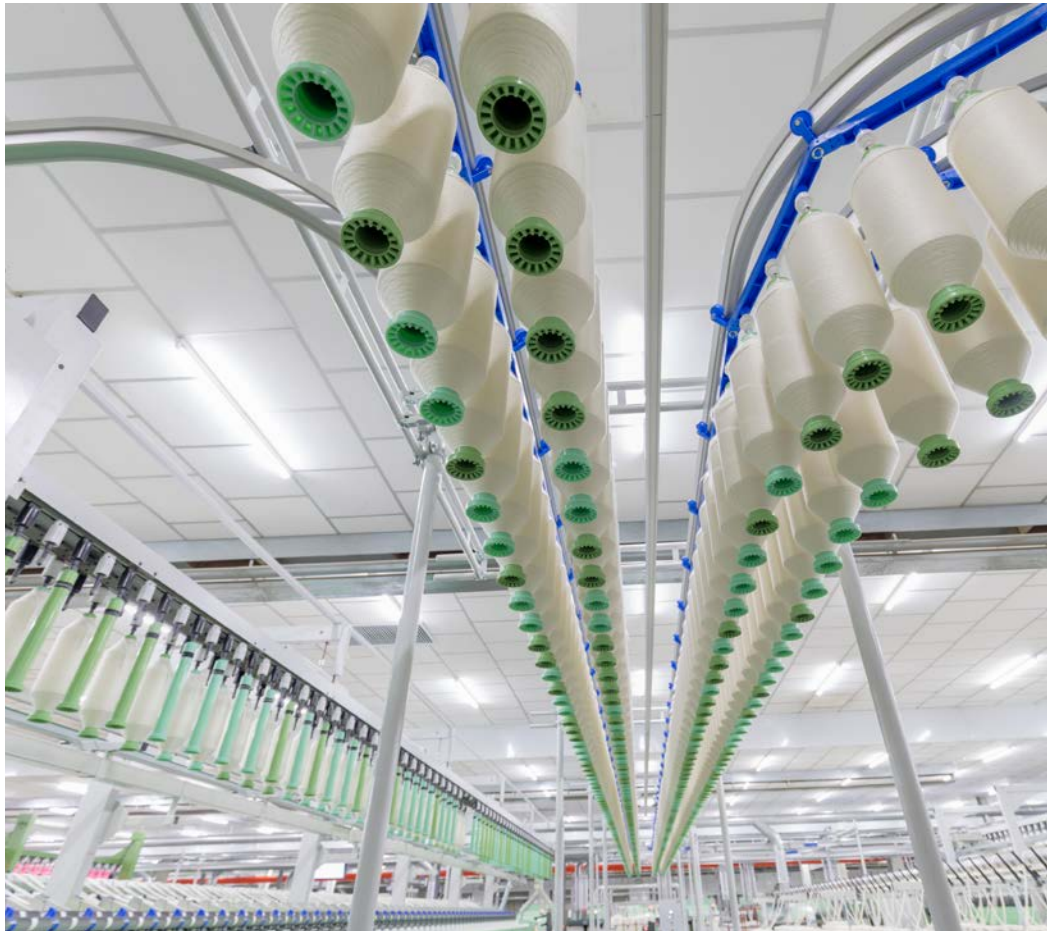
图6：粗纱纱管运输系统SERVOtrail有助于节约空间，还能提供更为安全的粗纱管临时储存方案。
