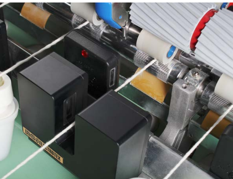
图4：粗纱张力控制和具有集成式数据分析功能的粗纱单锭监控可确保粗纱品质的一致性。
