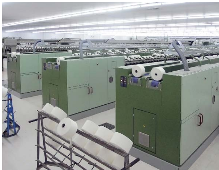
图7：泰国一家纺纱厂的BT 923纺纱机。2005年该机型首次突破100 000 rpm的神奇转速极限。
