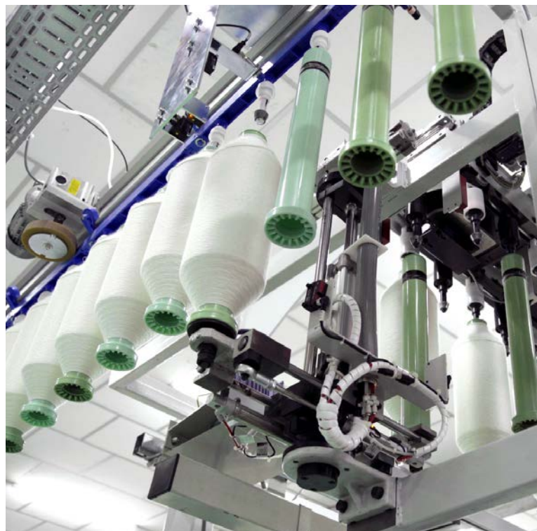
图3：纱管换筒装置可安装在机头或机尾处。这样的布置有利于和运输系统集成。
