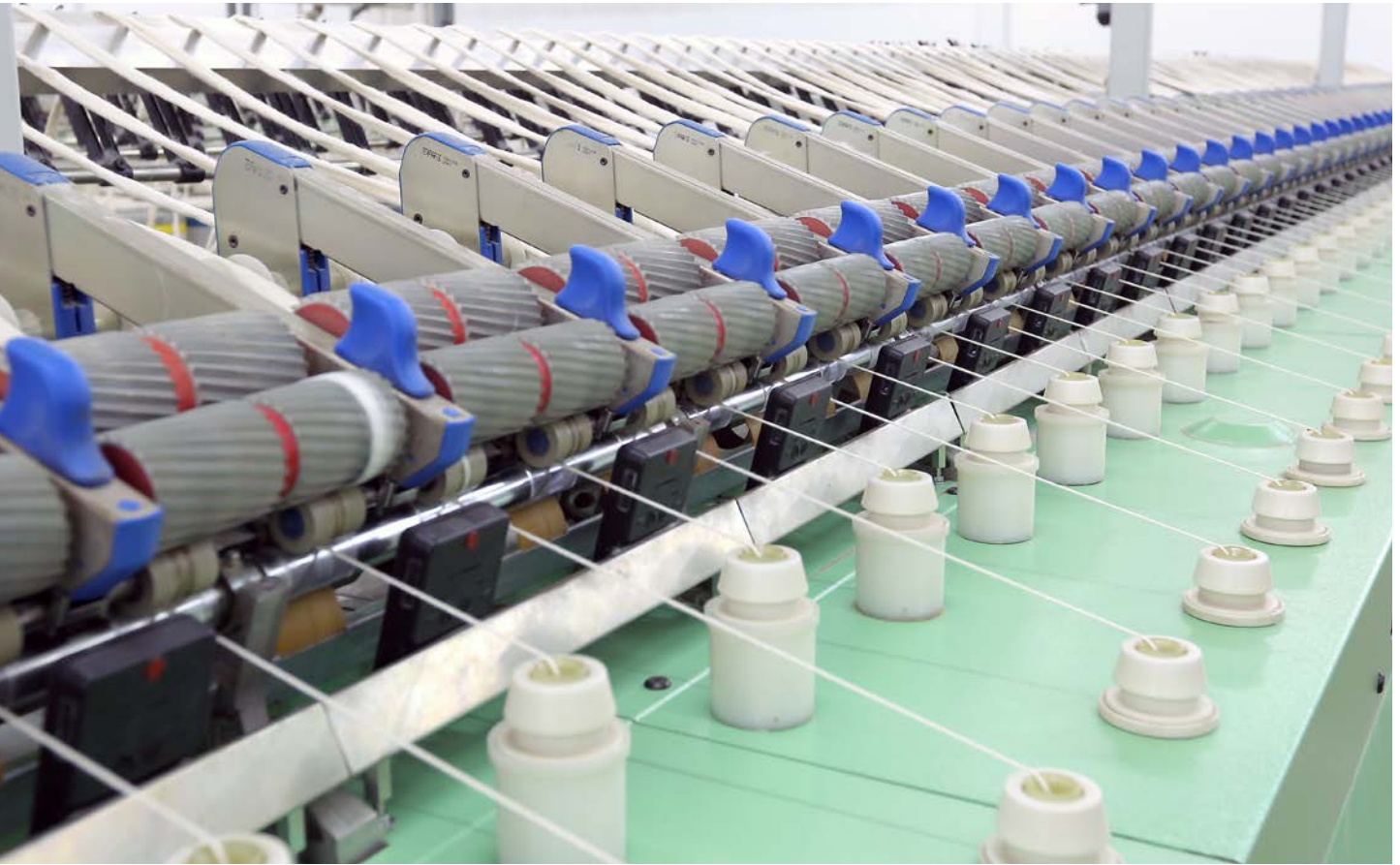
图4：粗纱张力控制和具有集成式数据分析功能的粗纱单锭监控可确保粗纱品质的一致性。
