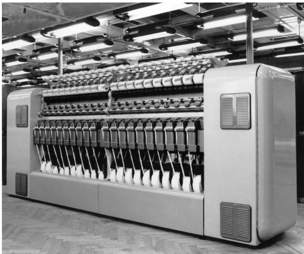
图1：全球首台转杯纺纱机模型，其中由分梳辊取代牵伸系统（M 40-V的基础）。
