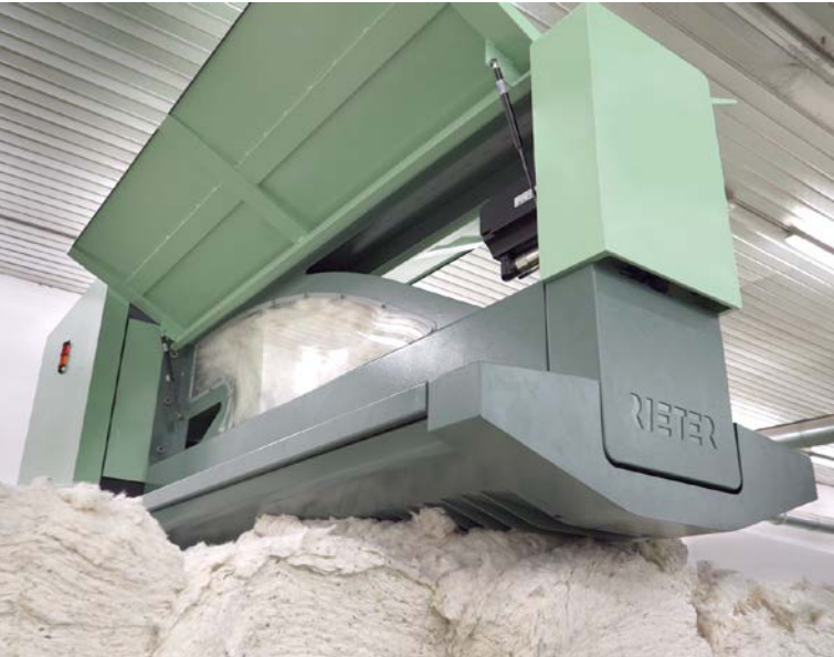
图2 得益于采用棉包扫描专利技术，在更换棉包组别后仍可达到高产量。
