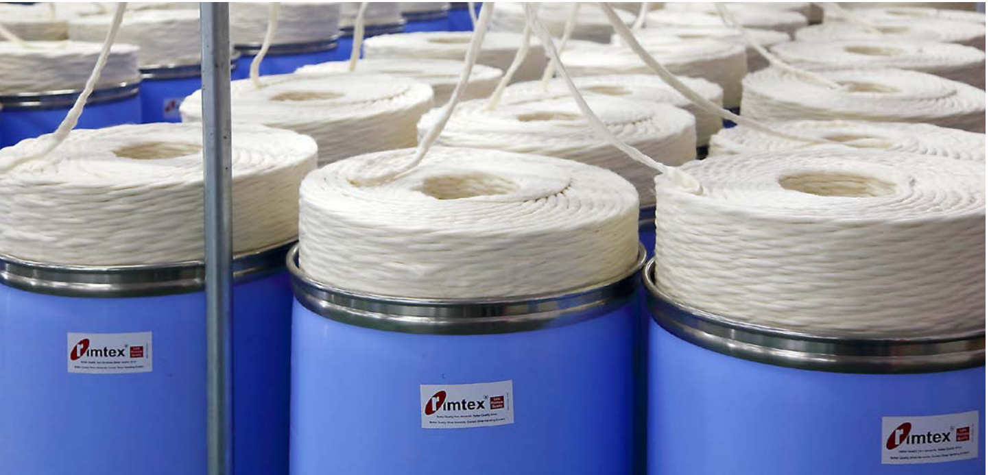
图1 Rimtex条筒确保精确的棉条圈条和完美的棉条抓取。
