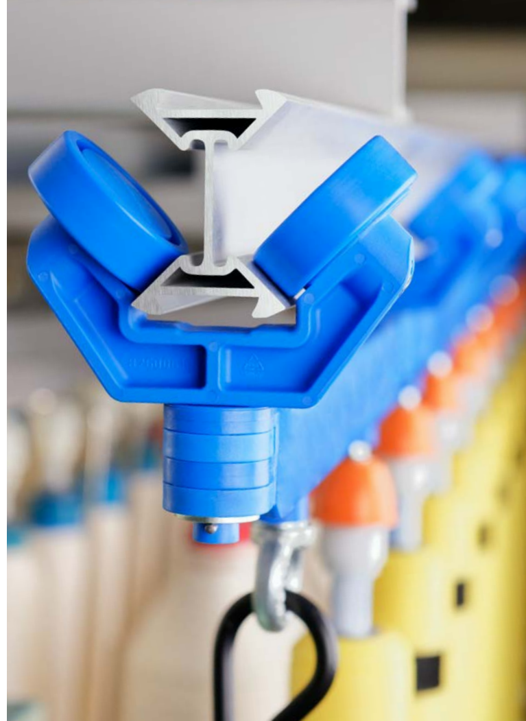
图4 这种铝型材的倾斜滑动面可以防止产生嵌花，从而实现免维护保养。
