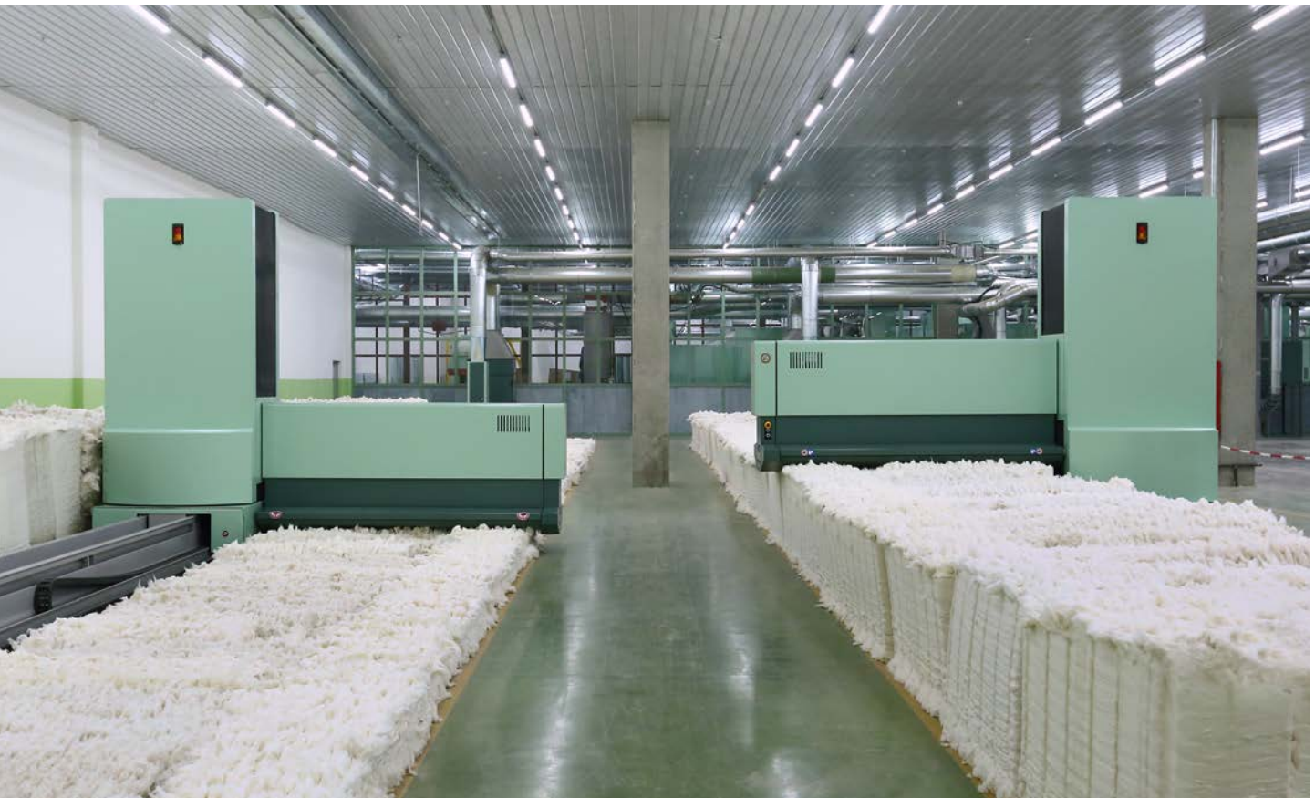
图1 抓棉机UNIfloc A 12 – 现代化的高效抓棉方法。
