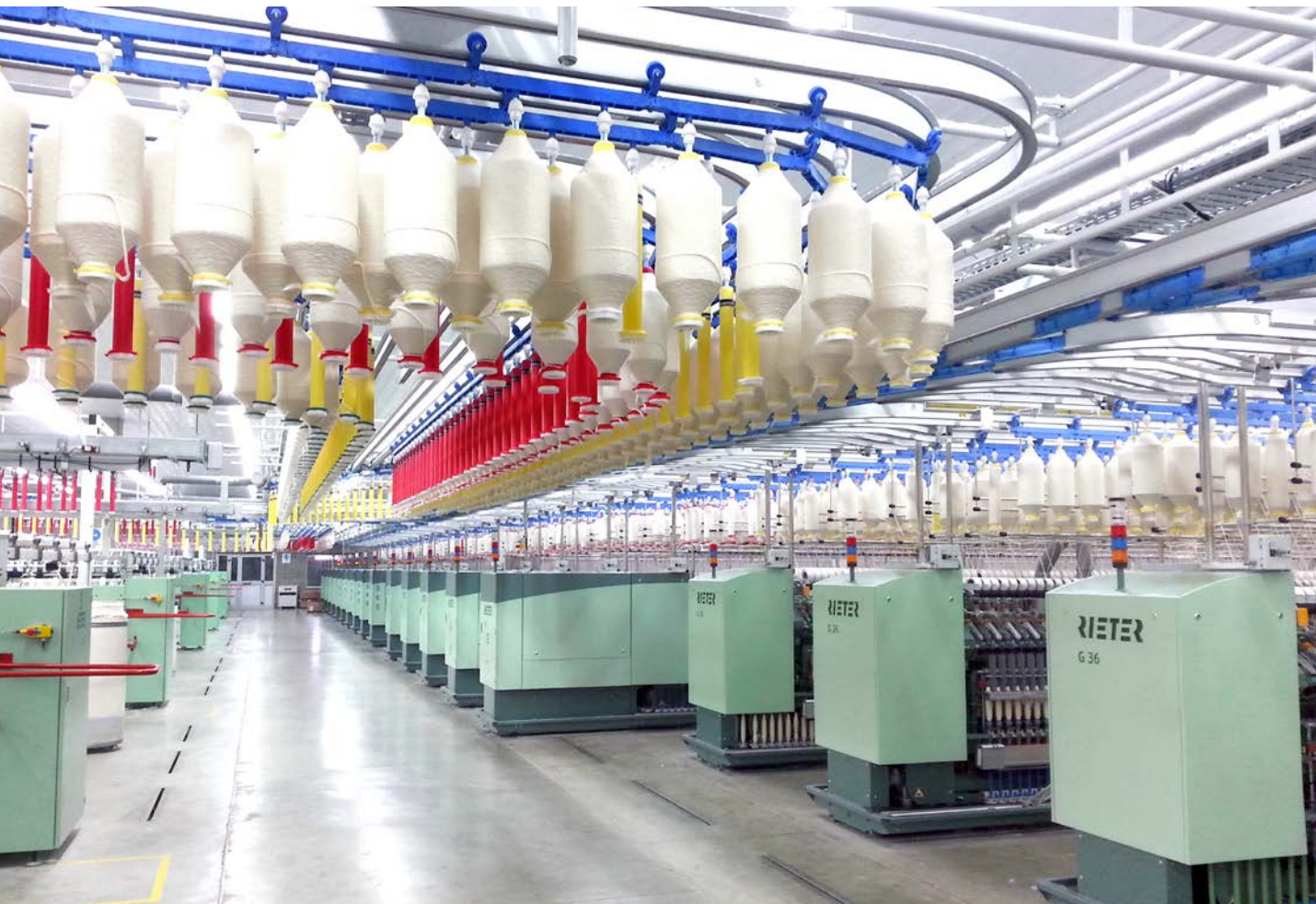
图3 完善的非接触式粗纱纱管运输确保稳定的质量。
