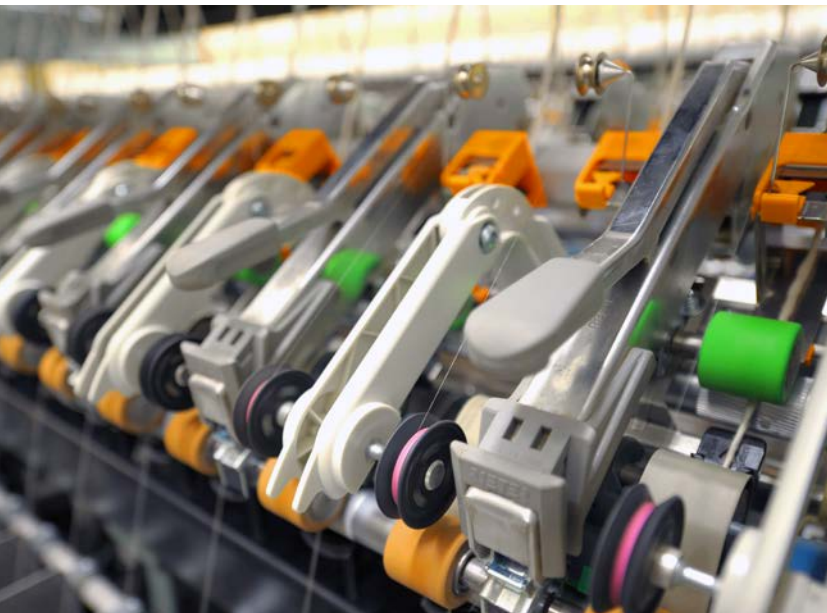
Şekil 2 Tüm uygulamalar için en iyi çözüm – özlü iplik aparatı ile Rieter ring iplik makinası.
