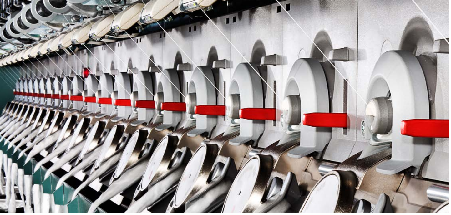
Şekil 1 Her iki uçtan emişli R 66 open end iplik makinası kayıpları minimize eder ve enerji tasarrufunu artırır.
