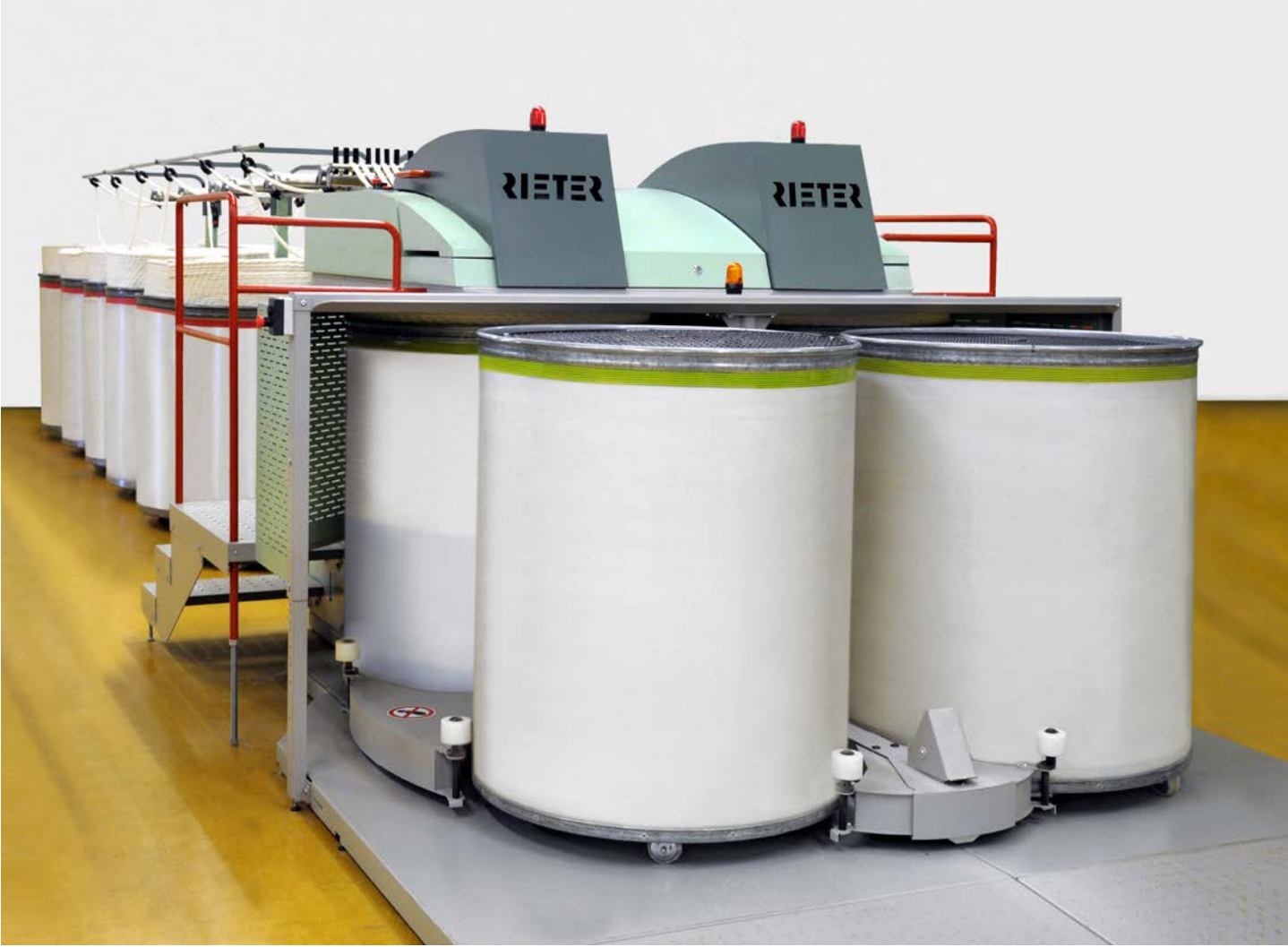
Şekil 7 Pamuk ile sun ve sentetik elyaf karışımları artış göstermektedir. SB-D 22 cer makinası lifleri karıştırmak için son derece uygundur.
