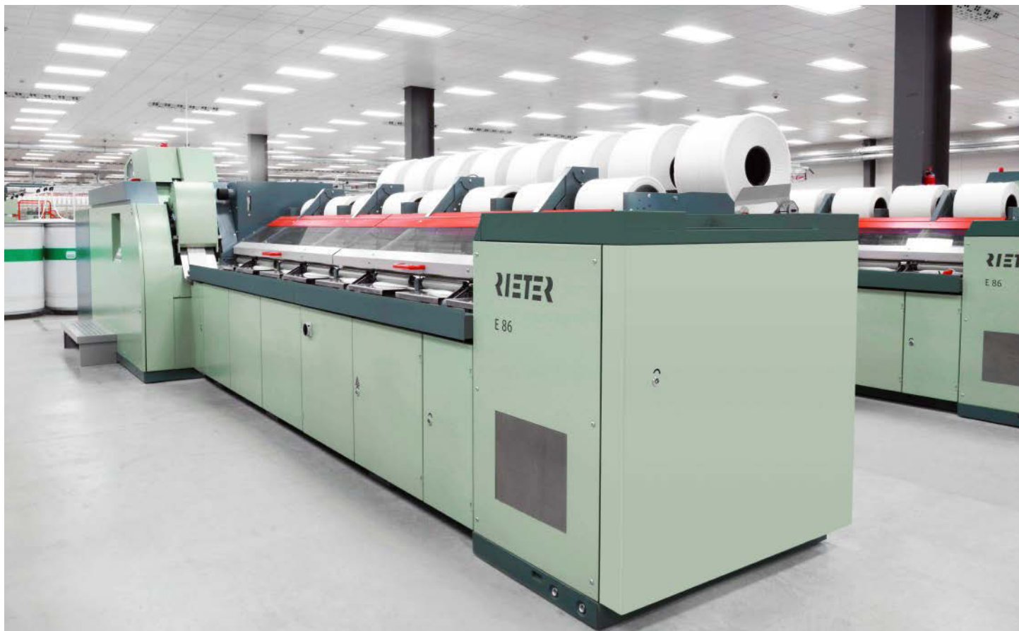
图2 配备ROBOlap的新型精梳机E 86可实现高质量和最高产能。
