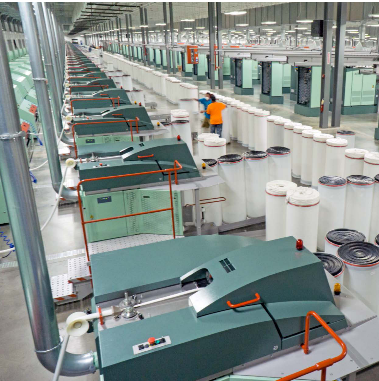
图2 带RSB模块的梳棉机C 70 - 转杯纺纱机缩短的流程和优化的条子准备。
