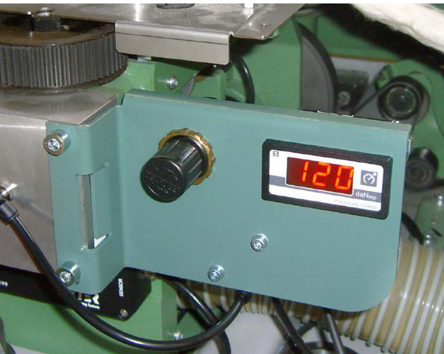
图1 在现有的并条机上，新型压缩空气监控装置PRESSUREguard可防止出现失控和劣质条子。
