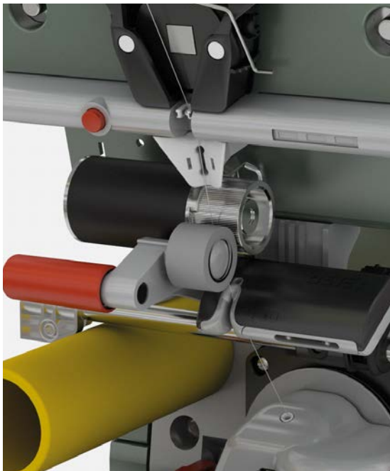
Salida con mando individual de AMIsSpin-Pro (arriba) o con árbol de rodillo de salida de AMIsSpin (derecha)
